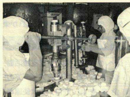
日本の大手スーパー向けおでん大根輪切り加工作業。大根の厚みも直径も均一に輪切り作業する。輪切り→煮沸→袋詰め→箱詰め(酢液詰めしているので常温で輸送)
